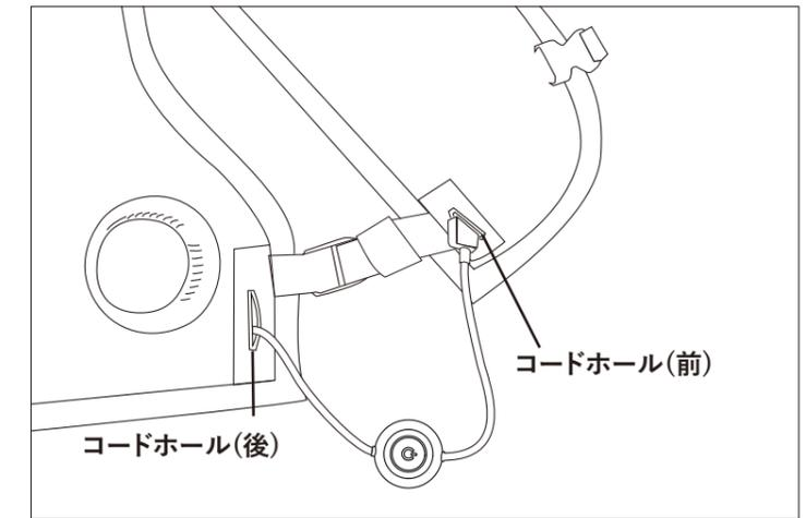
4 バッテリーをUSBプラグと接続してバッテリーポケットに収納する
