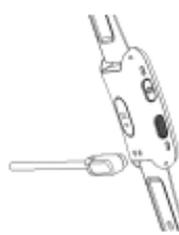
同梱されている専用の充電ケーブルをご使用ください。DC+ / - の銅端子が本体の充電ピンに正しく接触するようにしてください。DC+ / - の銅端子が逆に接続されると、充電ピンに正常に接触できず、充電ができなくなります。
